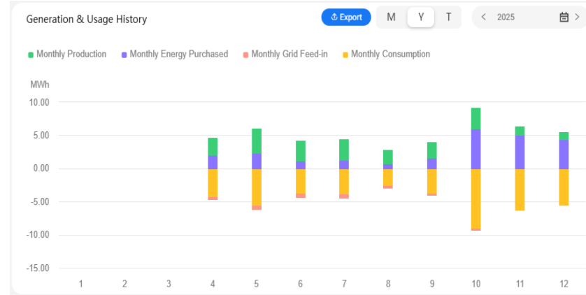
Рисунок 1 – Характер помісячного споживання і генерації електричної енергії для частини головного корпусу ІФНТУНГ (мережева ФЕС)
