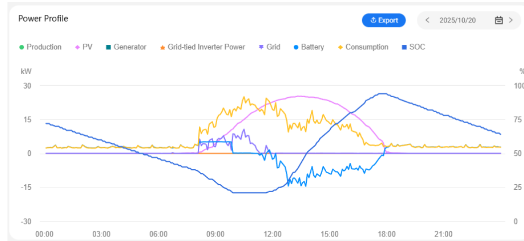
Рисунок 2 –Характерний приклад відсутності обмеження потужності для гібридної ФЕС головного корпусу ІФНТУНГ в режимі максимального самоспоживання (20.10.2025 р.)
