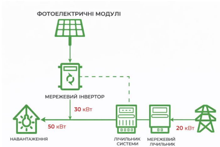
Рисунок 1 – Ілюстрація принципу роботи мережевої фотоелектричної станції під власне споживання
